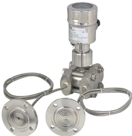
Благодаря использованию мембранных разделителей можно приспособить преобразователь дифференциального давления модели DPT-10 к наиболее трудным условиям в обрабатывающей промышленности. Таким образом преобразователи могут использоваться при экстремальных температурах, а также с агрессивными, коррозионными, неоднородными, абразивными, высоковязкими или токсичными средами. Благодаря широкому выбору асептических присоединений, например, клэмпов, резьбовой трубки или асептических присоединений
