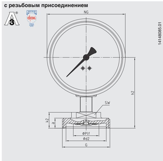
**Тип технологического присоединения: Асептическое резьбовое присоединение в соответствии с DIN 11864-1 форма А**
