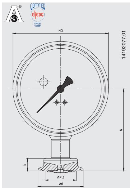
**Тип технологического присоединения: Клэмповое присоединение в соответствии с BS4825 часть 3**
