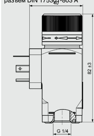
Технологическое соединение – G 1/4
