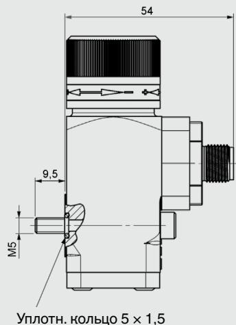
Технологическое соединение – G 1/4
