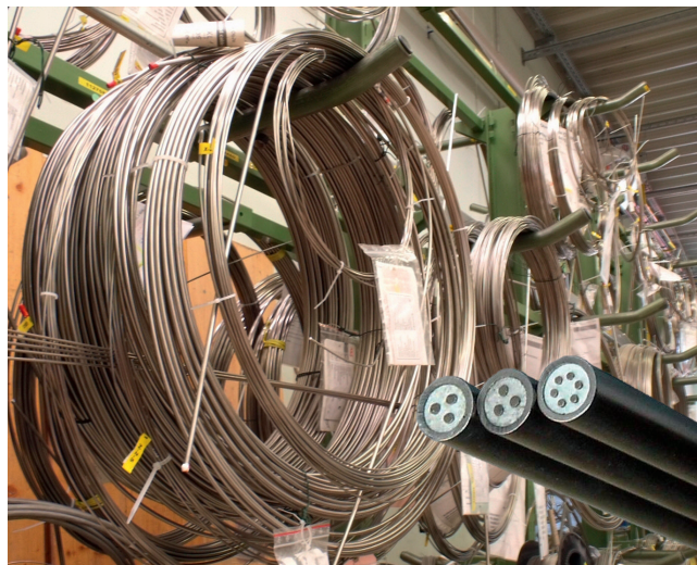
Кабель с минеральной изоляцией (МИ-кабель)
