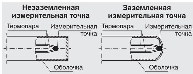
При измерениях температуры твердых тел диаметр отверстия, в которое должен вставляться чувствительный элемент, должен быть больше наружного диаметра чувствительного элемента максимум на 1 мм.
