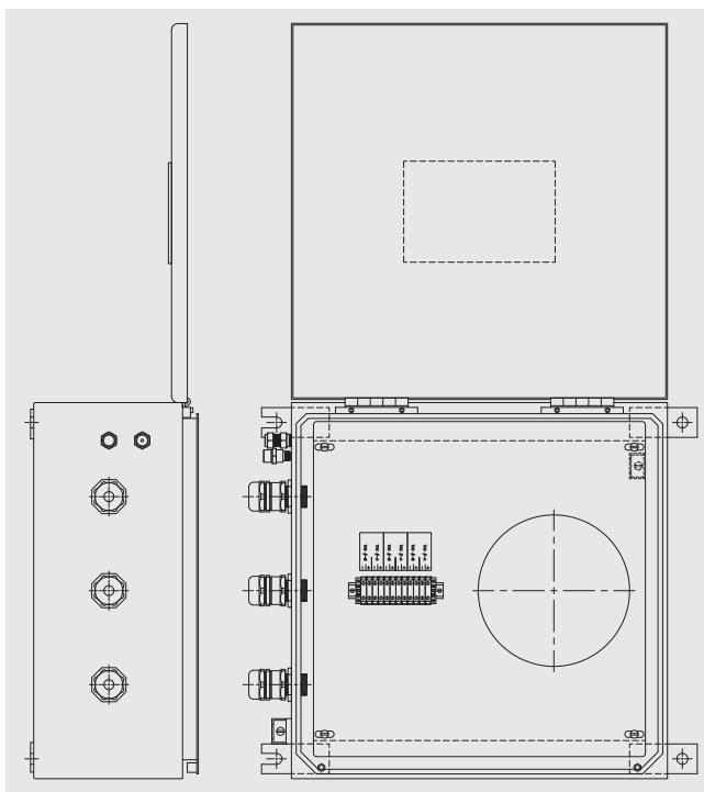
Данный корпус клеммного блока показан лишь в качестве примера возможной конфигурации. Конструкция корпуса клеммного блока зависит от требований конкретного применения и должна проектироваться отдельно для каждой сборки.
