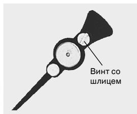
■ Для версий со встроенной электроникой передатчика должна быть установлена электрическая нулевая точка.
