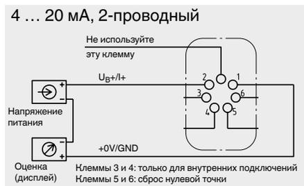
Для манометров с несколькими шкалами или в случае сменных подключаемых шкал (в виде опции), выходной сигнал 4 ... 20 мА, соответствующий каждой шкале, может сохраняться в микропроцессоре.
