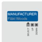
Кнопкой "UP" или "DOWN" выберите производителя вентилятора.
