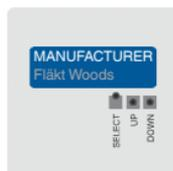
Кнопками "UP" или "DOWN" выберите требуемого производителя вентилятора.
