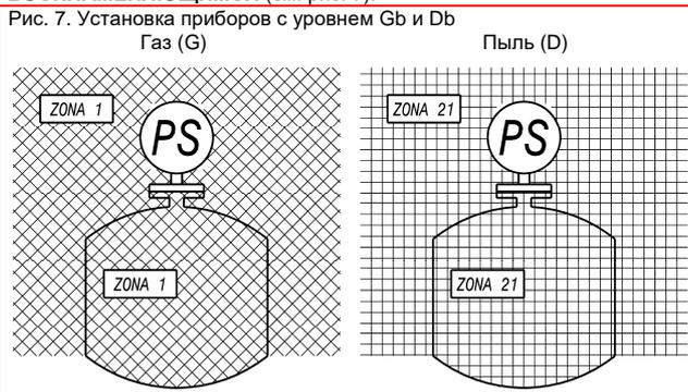
Рис. 7. Установка приборов с уровнем Gb и Db
