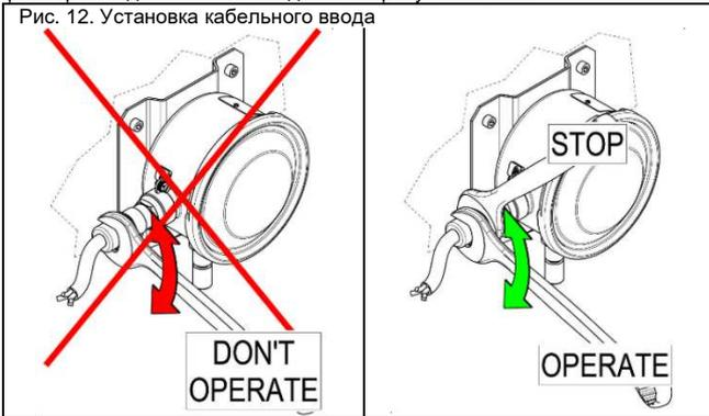
Рис. 12. Установка кабельного ввода
