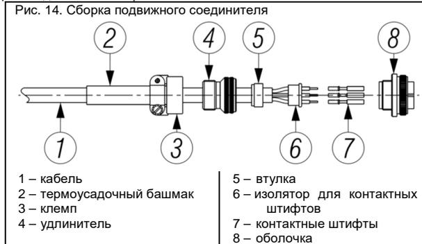
Рис. 14. Сборка подвижного соединителя
