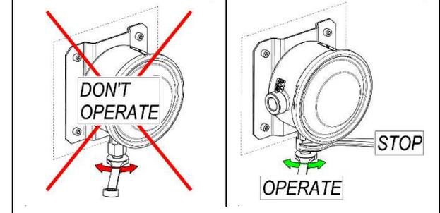
**Выполните** присоединение к процессу посредством гибкого шланга таким образом, чтобы изменения температуры самой трубы не влияли на подключение измерительного прибора.
