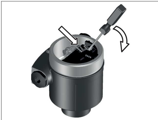
Рис. 33: Подключение к источнику питания: шаги 6 и 7
