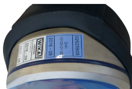
Рис. 2 - GDI-100-D с защитным резиновым чехлом
