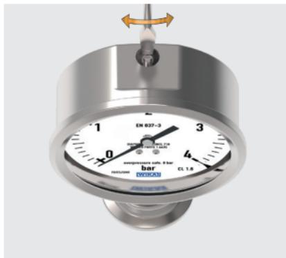
Подстройка нуля может выполняться с помощью плоской отвертки после удаления заглушки сверху корпуса.
