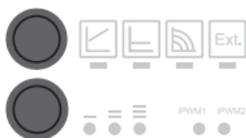
**Функция синхронизации** активируется путем одновременного нажатия на верхнюю и нижнюю кнопки управления.
