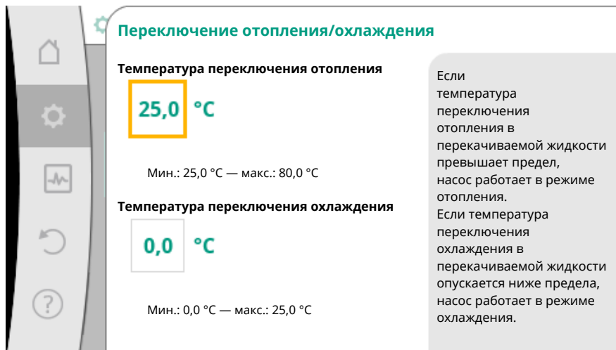
Fig. 57: Переключение отопления/охлаждения_Температуры переключения
