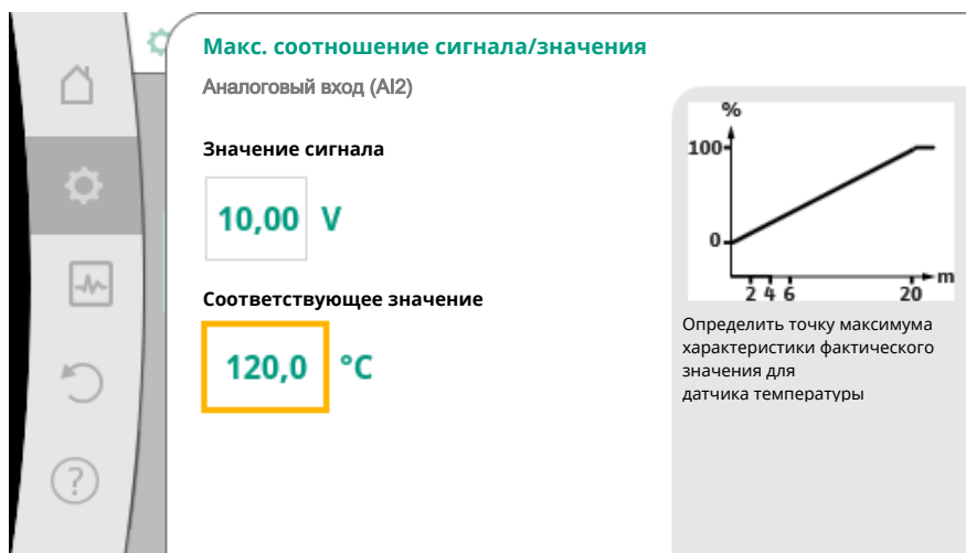
Fig. 81: Макс. соотношение сигнала/значения, датчик фактического значения
