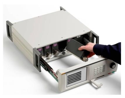
Модуль регулировки давления PCM-STD-20М и модули измерения давления PM200/PM600 размещены в отдельных блоках, что позволяет легко и быстро заменять их.
