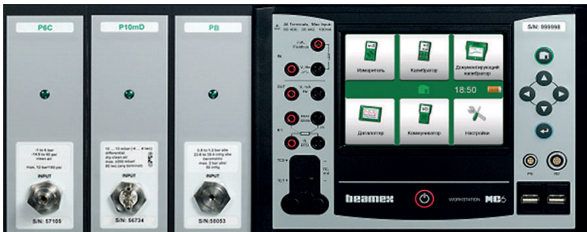
Измерение и задание давления и электрических сигналов
