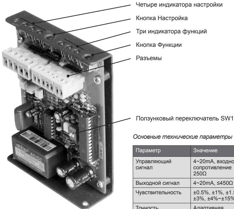
Рис.1 Внешний вид контроллера ЭПК
