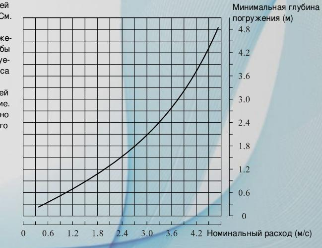
Рис. Рекомендуемая глубина погружения всасывающей трубы
