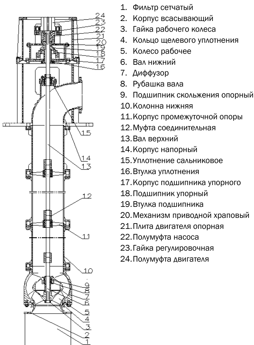
Рис. 21 Конструкция насоса VTP с открытым валом
